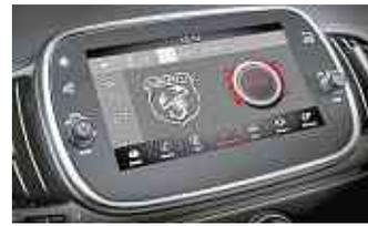
mentsystem. Diese steht für die Übertragung des Smartphone-Bildschirms auf den Monitor, wodurch sich die Funktionen des Smartphones über den bordeigenen Bildschirm steuern lassen.
