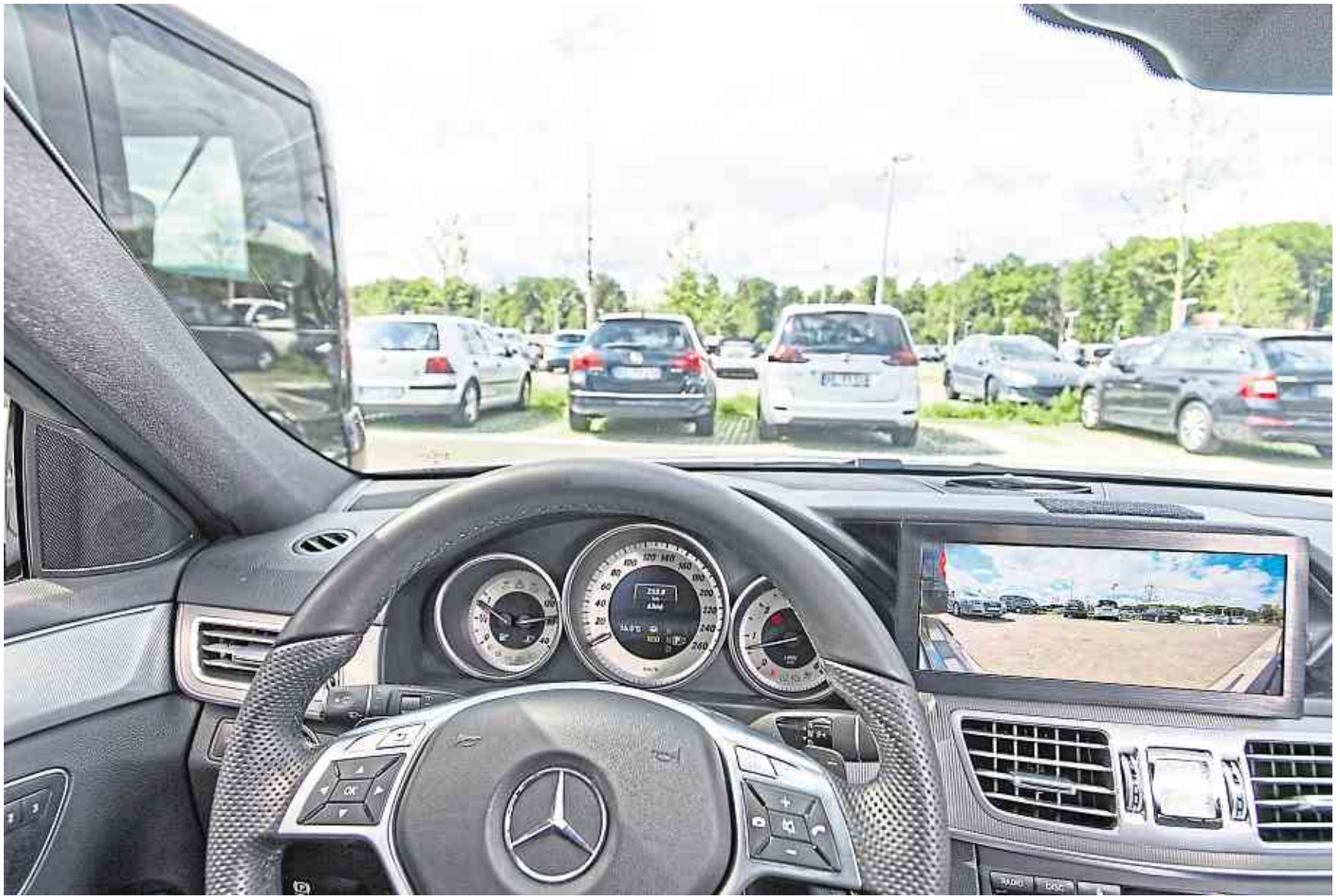
Die Panorama-Ansicht (180 Grad) ermöglicht sicheres Ausparken bei querendem Verkehr.
