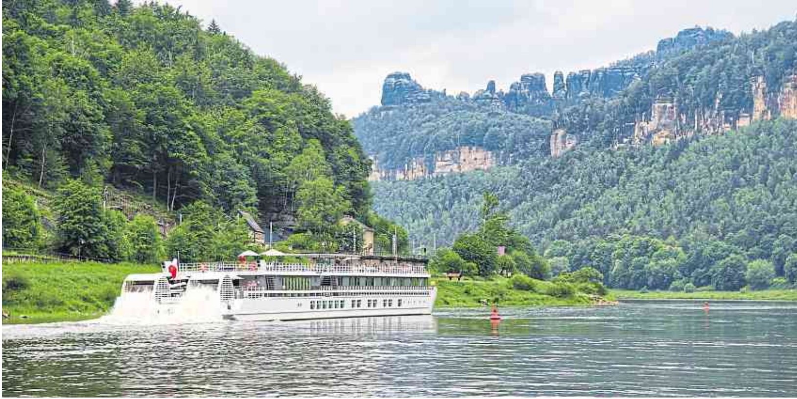
Dank Schaufelradantrieb können Flusskreuzfahrtschiffe wie die „Elbe Princesse“ auch weniger tiefe Flüsse befahren.
