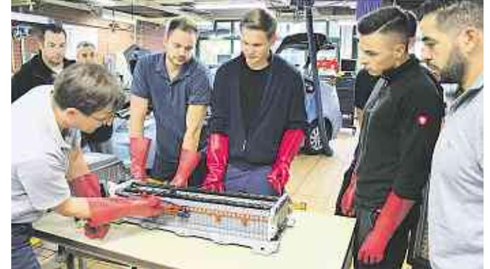
Spannungsmessung an einer E-Auto-Batterie.
