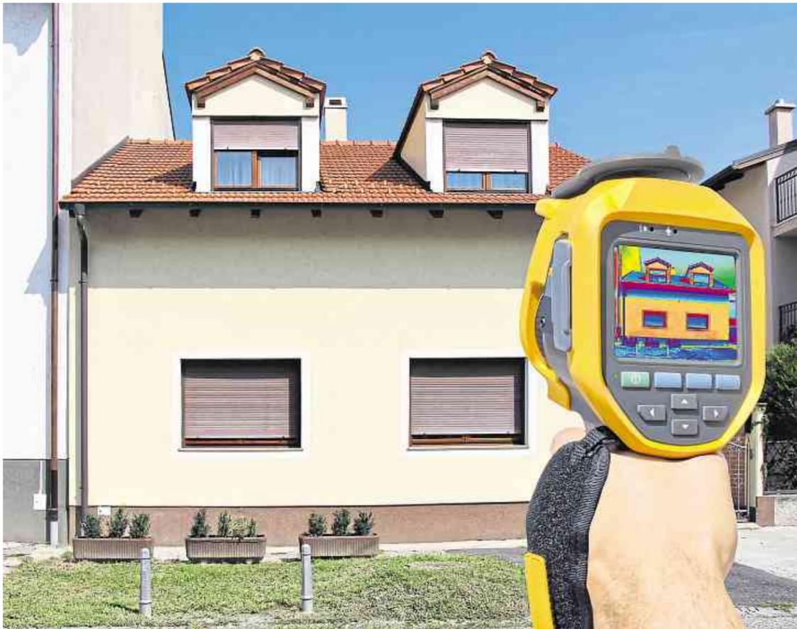
Erst den Ist-Stand analysieren, dann einen konkreten Sanierungsfahrplan aufstellen. Mit einem Infrarot-Messgerät kann der Energieberater Schwachstellen in der Gebäudehülle identifizieren.
