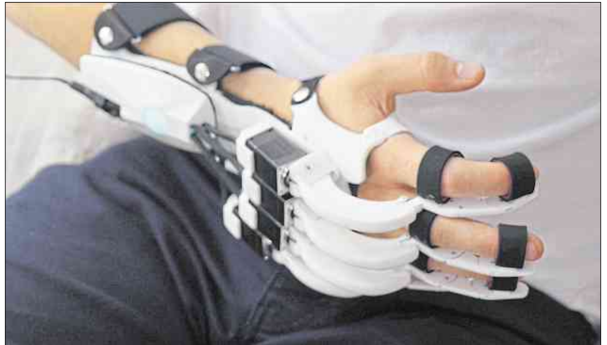
Das Therapiegerät Herax der Lime Medical GmbH kann Patienten und Therapeuten dabei unterstützen, nach einem Arbeitsunfall oder Schlaganfall deutlich bessere Heilungsergebnisse an der Hand zu erzielen. Foto: LIME Medical
