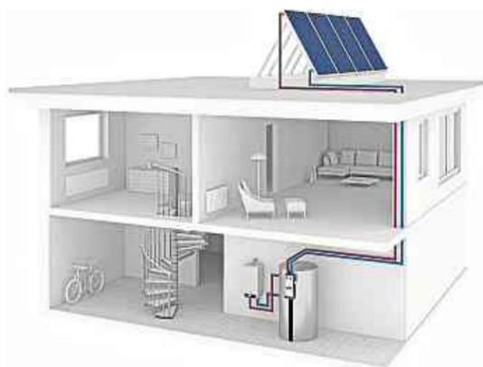
Ausrichtung, Neigungswinkel und Fläche der Solarkollektoren sind die ausschlaggebenden Faktoren, die über die Effektivität der Solarthermie entscheiden.
