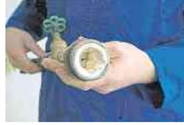
**Sie sehen keine Fotomontage! Kalk aus dem Wasser kann Rohrleitungen dermaßen 'verengen, dass die Wasserdurchfluss zum Problem werden kann.** Foto: Grünbeck
