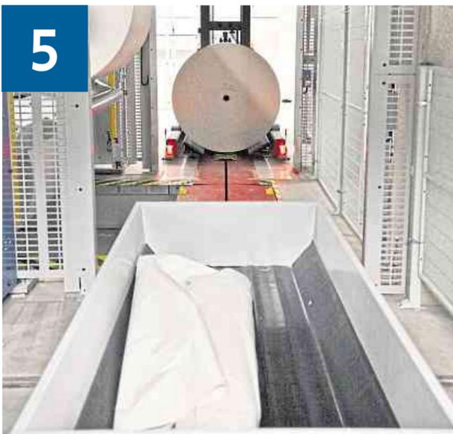
..., welcher die neue Papierrolle dem automatischen Rollenwechsler der Druckmaschine zuführt.
