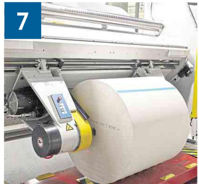
Die neue Rolle rückt automatisch an die richtige Stelle - fertig zum Einsatz.
