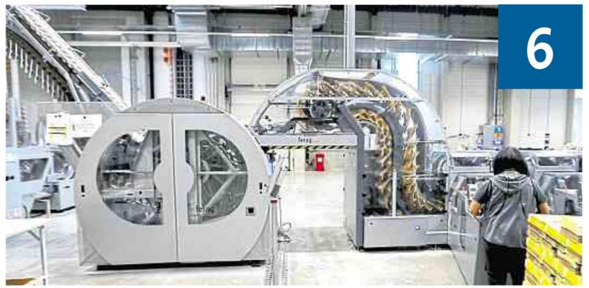
Im Herzstück der Anlage - der Trommel - werden die Zeitungen, die von links in die Trommel transportiert werden, mit den von rechts kommenden Beilagen „verheiratet“.
