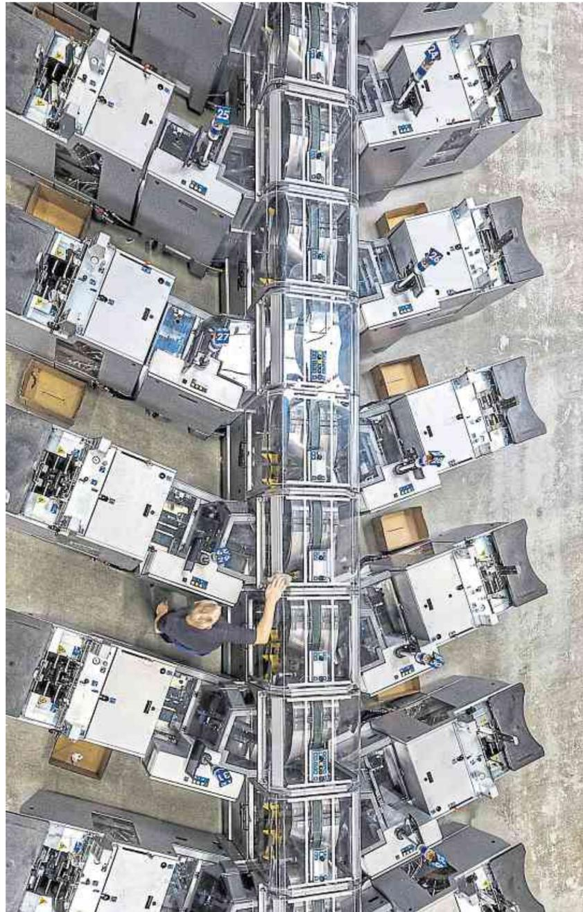
Die Ausmaße der Anlage verhindern, dass selbst das beste Weitwinkelobjektiv die Installation von oben einfangen kann. Allein eine Anlagenstrecke hat eine Länge von 40 Metern. Damit dort alles reibungslos läuft, ist die Maschine komplett digital und überwacht sich selbst.
