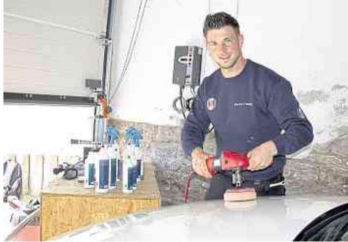
Bei der Außenaufbereitung von Fahrzeugen nutzt Sascha Frenger maschinelle Schleif-, Hochglanz- und Antihologramm-Politor. Auch der Lack wird maschinell versiegelt.
