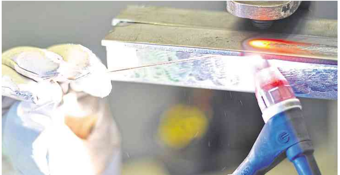
WIG-Schweißen in schwieriger Nahtlage.
