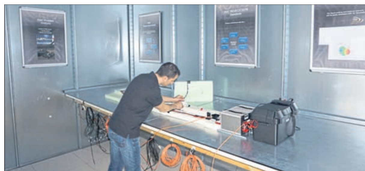
In Schirmkammern, die wie faradaysche Käfige funktionieren, messen die ZF-Entwickler Strahlungsemissionen und testen, wie etwa ein Kamera-Sensor auf Frequenzen von Funkwellen oder WLAN reagiert.
