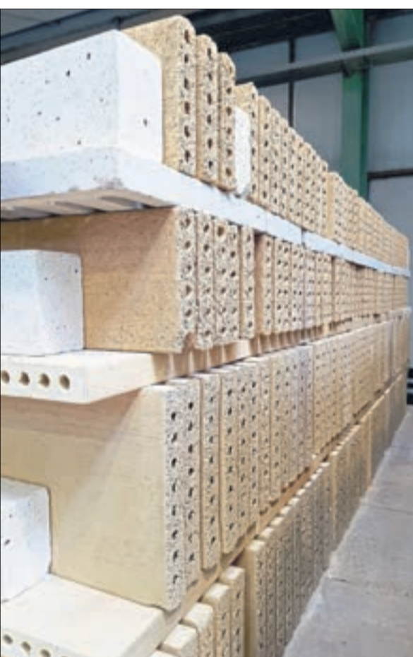
Schamottsteine sind feuerfest und werden deshalb unter anderem für den Ofenbau verwendet. Außerdem speichern sie Wärme.
