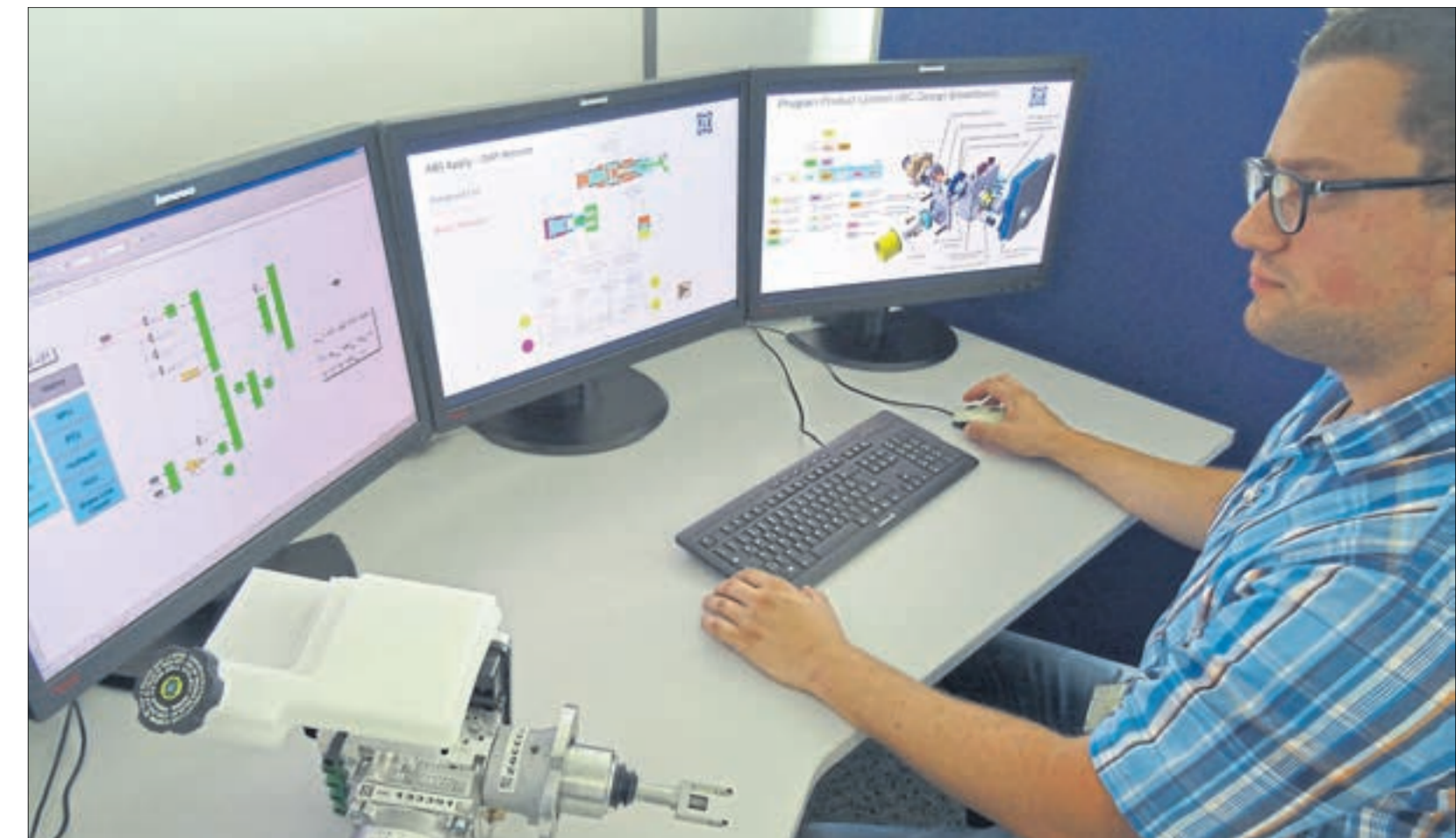
Hochleistungsrechner simulieren das reale Fahrverhalten von Fahrzeugen – hier von einem Bremssystem – über eine Dauer von 24 Stunden. Allein in einer Nacht sind rund 2000 Tests möglich. Der Computer liefert damit Test-Ergebnisse, die mit realen Fahrzeugen in mehreren Wochen kaum realisierbar wären.
