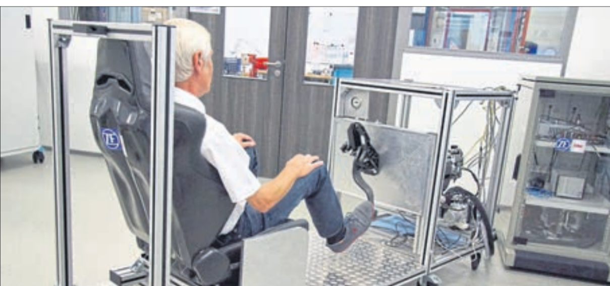
Eine Vorrichtung, die Autositz, Pedal und Bremsanlage kombiniert, ermöglicht den ZF-Prüfern die haptische und taktile Wahrnehmung von Bremsalgorithmen. So können sie den einzelnen Automodellen angepasst werden.
