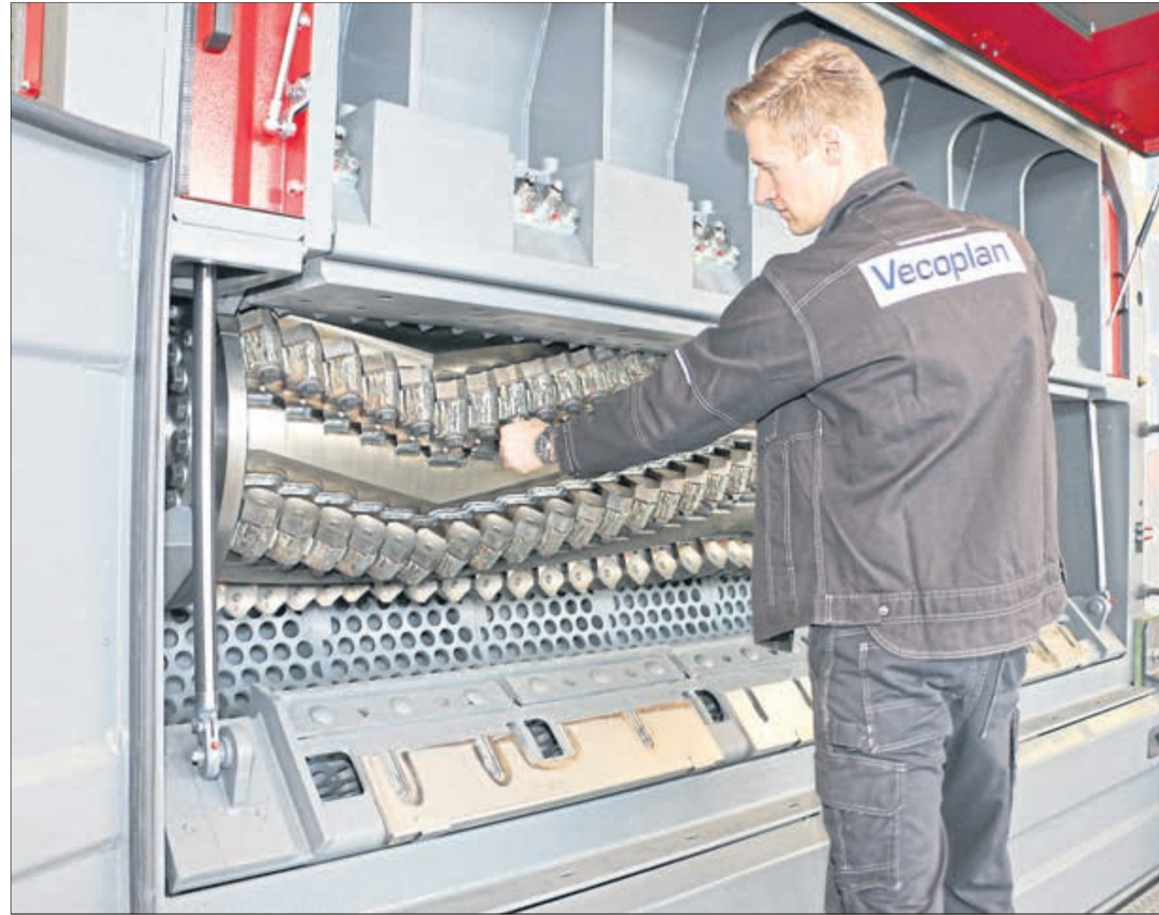
Der Rotor ist das Herzstück einer jeden Zerkleinerungsmaschine. Damit lassen sich verschiedene Materialien, wie Kunststoff, Holz oder Biomasse zerkleinern.
