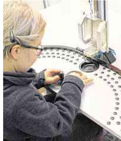
**Dieser ergonomische Arbeitstisch verfügt u.a. über taktile Führungen, die zum Leiten von Bauteilen dienen. Dies befähigt insbesondere blinde und sehbehinderte Menschen zum selbstständigen Arbeiten.** Foto: Caritas-Werkstätten Westerwald-Rhein-Lahn
